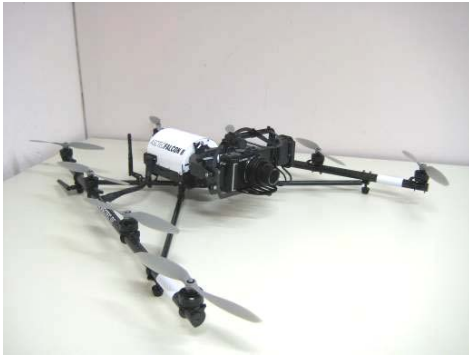
Abb. 29: Unbemanntes Flugobjekt "Ascending Technologies Falcon 8" (a) mit mobiler Bodenstation (b). Zur Unterstützung bei der Aufnahme wird die Kamera automatisch stabilisiert. An der Bodenstation sind neben dem Auslesen der Telemetriedaten auch Bildvorschau, Zoom und Schwenkung der Kamera möglich.
