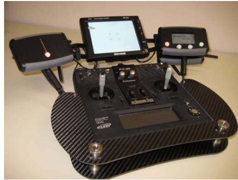
Abb. 29: Unbemanntes Flugobjekt "Ascending Technologies Falcon 8" (a) mit mobiler Bodenstation (b). Zur Unterstützung bei der Aufnahme wird die Kamera automatisch stabilisiert. An der Bodenstation sind neben dem Auslesen der Telemetriedaten auch Bildvorschau, Zoom und Schwenkung der Kamera möglich.
